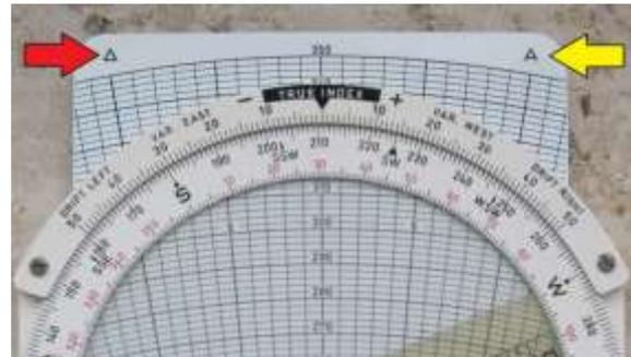
Vorüberlegung: Bei den gegebenen Parametern kommt der Wind von links hinten. Daraus ergibt sich eine Rückenwindkomponente, so daß die Grundgeschwindigkeit ( $V_G$ ) höher sein muß als die Eigengeschwindigkeit ( $V_E$ ). Außerdem ergibt sich eine Seitenwindkomponente von links, woraus sich ein negativer Luvwinkel ergibt.
